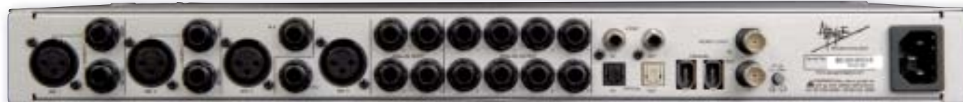
Die beiden optischen Anschlüsse, links neben den Firewire-Buchsen, lassen sich im S/PDIF- oder im ADAT/SMUX-Modus betreiben. Je zwei Send- und Return-Anschlüsse bereichern die Eingänge eins und zwei (links).
