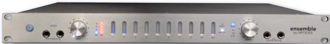
Die Front des Ensemble ist klar strukturiert. Mit den beiden Drehreglern lassen sich die Mikrofonverstärkung (linker Regler) und die Abhörlautstärke justieren.
