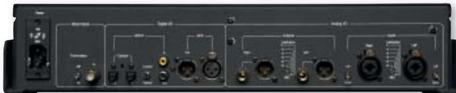
Praxisgerecht sind die beiden Trim-Regler, um sowohl Ein- als auch Ausgangspegel für das jeweilige Setup optimal zu kalibrieren.
