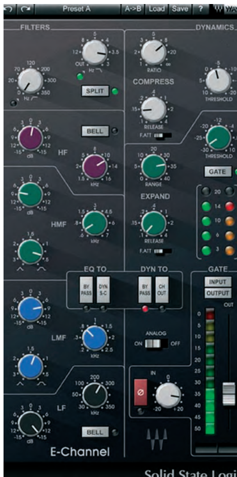
Der E-Channel enthält den Equalizer und die Dynamik Sektion des Kanalzuges einer SL 4000E Konsole. Durch die vier Schalter in der Mitte und den Split-Schalter oben links lassen sich Filter, Equalizer und Dynamiksektion unterschiedlich miteinander verschalten. Vehemente Klangänderungen sind mit dem Plug-in möglich. Zusätzlich verleiht er anliegenden Signalen Wärme und Körper.
