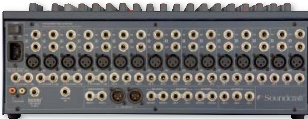
Das Anschlussfeld des FX16ii: Jeder der 16 Monokanäle hat einen Direktausgang und einen eigenen Einschleifweg. Auch die beiden Subgruppen (Sub L und Sub R) und die Hauptausgänge verfügen über einen Einschleifweg. Hinzu kommen vier Stereo>Returns, drei Auspielwege und auch ein 2-Track-Cinch-Eingang fehlt nicht.
