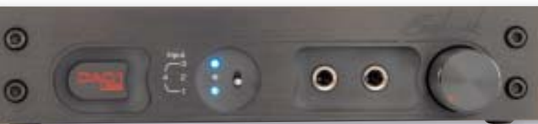
Der DAC1 USB sieht dem älteren DAC1 verblüffend ähnlich: Neu ist das USB-Interface, außerdem verarbeitet der Neue nur noch AES/EBU- und S/PDIF-Signale.
