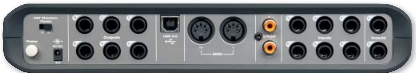
Die analogen Line-Eingänge auf der Rückseite müssen per Front/Rear-Button auf der Vorderseite aktiviert werden. Für Kanal 1 und 2 gibt es einen Insertweg, um externe Effekte einzuschleifen.
