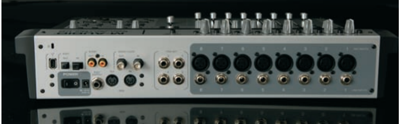
Das Anschlussfeld des Project-Mix hält vielfältige Möglichkeiten bereit. Die optischen Schnittstellen können über die Control-Panel Software von ADAT auf S/PDIF umgeschaltet werden.
