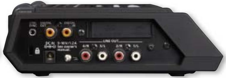
Ausgangsseitig finden sich vier Cinchbuchsen, wahlweise als Mono-Outs oder zwei Stereo-Outs konfigurierbar, sowie ein coaxialer S/PDIF-Ein-/Ausgang und eine Klinkebuchse zur Synchronisation mit einem zweiten R-44. Hinter der Abdeckung verbirgt sich ein Mini-USB-Anschluss sowie das SD-Kartenfach.
