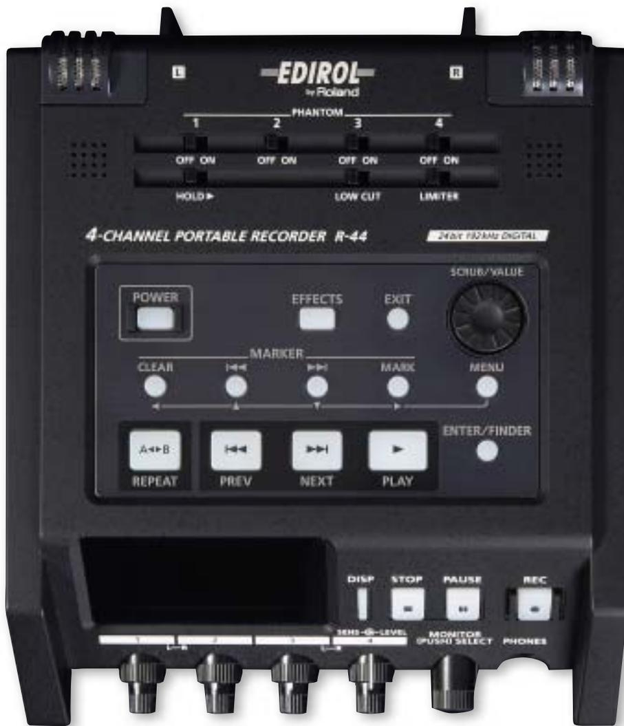
Der R-44 Vierspur-Recorder wartet mit zwei integrierten Mikrofonen und Lautsprechern auf. Die vier Analog-Eingänge lassen sich separat einpegeln und verfügen über separat aktivierbare Phantomspeisung. Eine integrierte Effektsektion sowie Lowcutfilter und Limiter in den Eingängen bieten ein zusätzliches Plus an Ausstattung.
