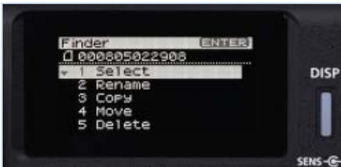
Durch Druck auf die Enter/Finder-Taste zeigt das Display eine Dateistruktur mit sämtlichen auf der Karte befindlichen Aufnahmen. Ein nochmaliger Druck auf die Finder-Taste offeriert Funktionen zur Bearbeitung einer zuvor ausgewählten Datei.
