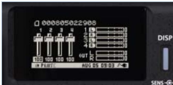
Durch Druck auf den Disp-Taster erscheint ein Mixer-Dialog über den sich die Lautstärke der vier Analogausgänge regulieren lässt. Die Pegel der Analogeingänge werden dadurch nicht beeinflusst.
