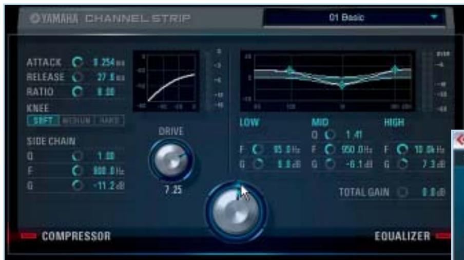
Der Sweet Spot Morphing Channelstrip enthält einen separat aktivierbaren Kompressor und Dreiband-Equalizer, die mit den herkömmlichen Parametern editierbar sind. Der Clou: Über den Morph-Regler in der Mitte lässt sich nahtlos zwischen fünf Einstellungen überblenden.
