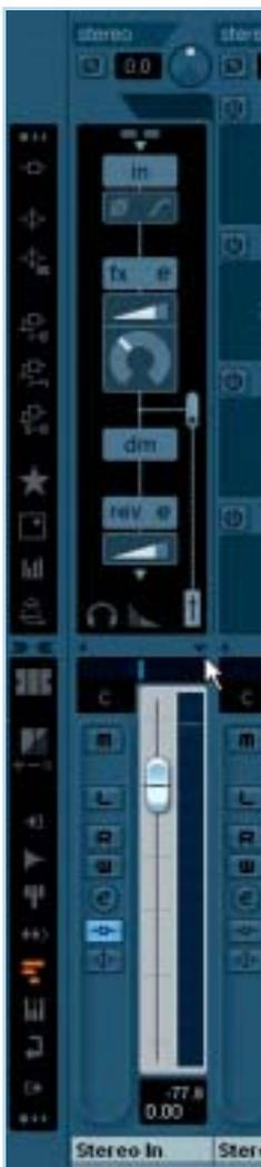
Die Steuermöglichkeiten der Audio-Interface-Eingänge sind direkt in den virtuellen Mixer von Cubase 4.5 integriert.
