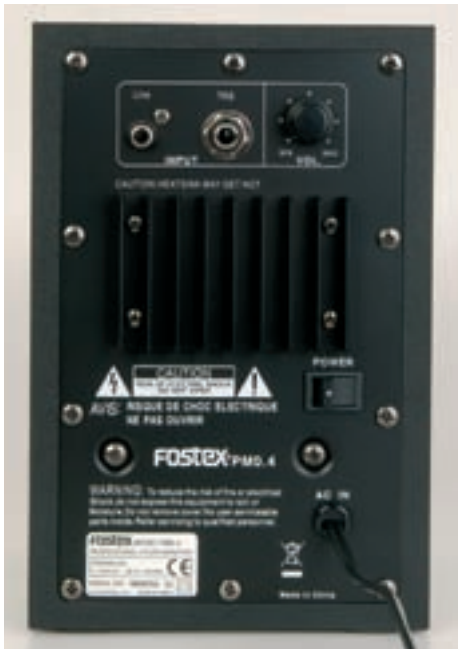
Der Fostex PM0.4 hat nur symmetrische und unsymmetrische Klinkeneingänge, XLR-Kabel können nicht angeschlossen werden. Das Netzkabel ist fest angeschlossen.
