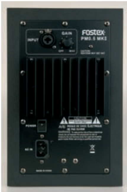
Der Combo-Anschluss des Fostex PM0.5 MK II nimmt sowohl XLR- als auch Klinkenkabel auf. Regelmöglichkeiten zur Raumanpassung gibt es nicht.
