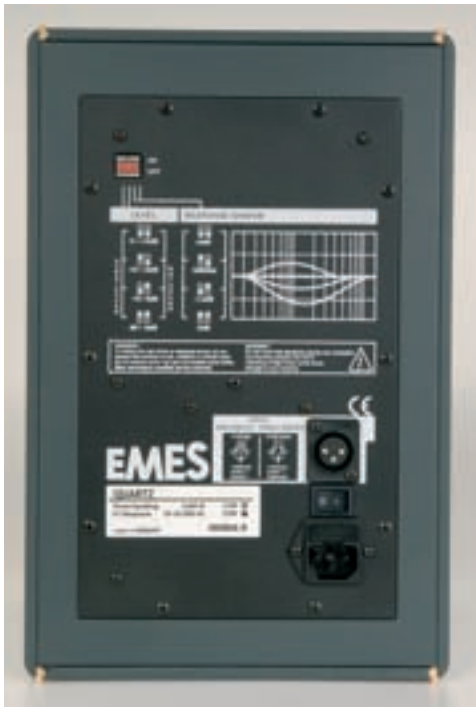
Der Emes Quartz hat anstelle eines Lautstärkereglers zur Pegelanpassung drei DIP-Schalter. Hiermit lässt sich der Pegel auf vier Empfindlichkeitsbereiche einstellen.
