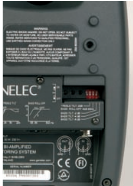
Die versenkten DIP-Schalter des Genelec über die der Lautsprecher an den Abhör-raum angepasst werden kann, sind ohne Werkzeug kaum zu verstellen.
