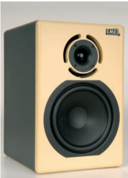
Der Emes Quartz hat drei Bassreflexöffnungen, die sternenförmig um den Hochtöner angeordnet sind. Diese „Bi-Port“ genannte Konstruktion sorgt für eine punktgenaue Klangabstrahlung.
