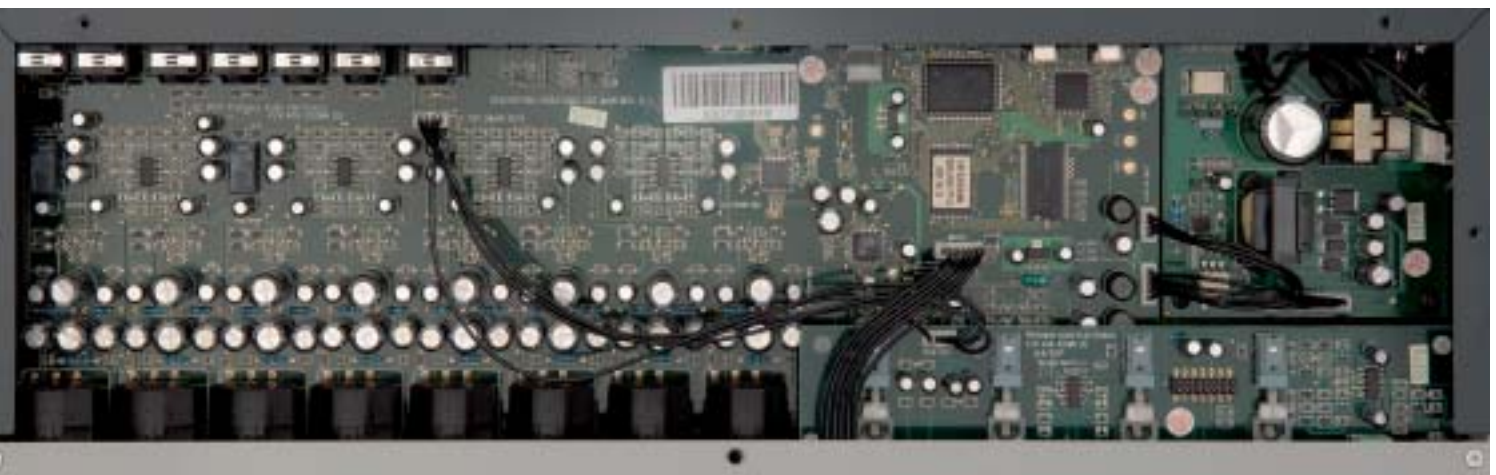
Presonus verwendet in jedem der acht Kanäle eigens entwickelte, diskrete Mikrofon-Vorverstärker in Class-A-Schaltung.
