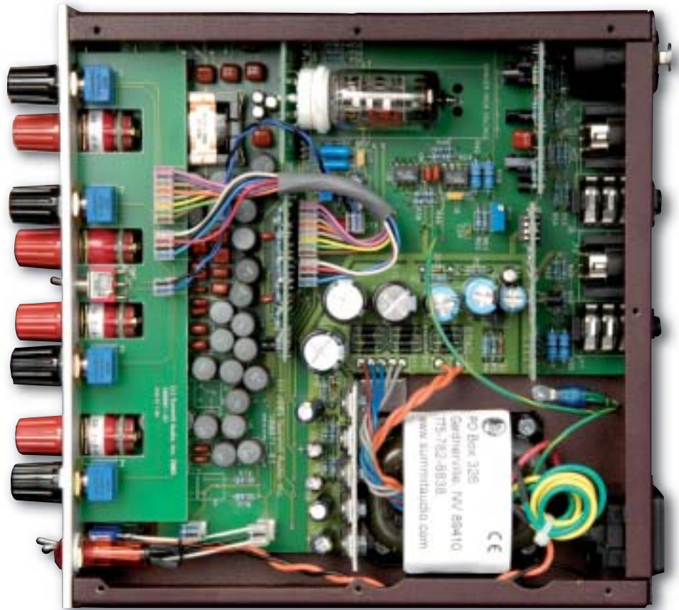
Alle drei Geräte verfügen über eine Röhren-Ausgangsstufe, die mit einer abgeschirmten ECC83 bestückt ist.
