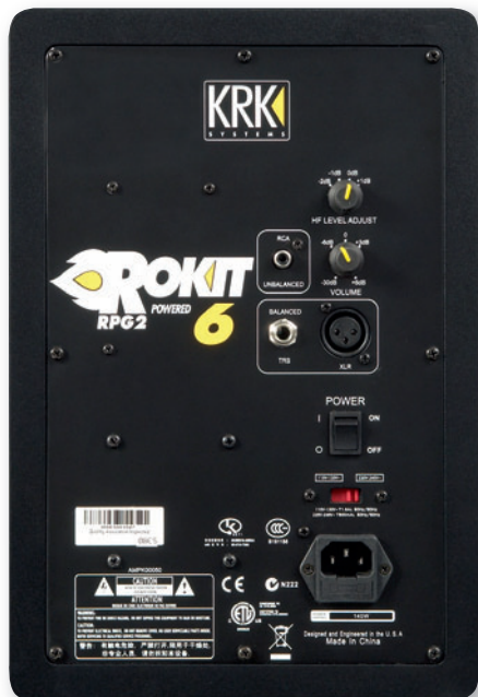
Der RP6G2 ist ein vergleichsweise puristischer Lautsprecher der kaum Anpassungsmöglichkeiten bietet. Lediglich der Pegel des Hochtöners ist einstellbar.
