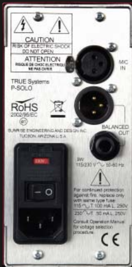
Auf der Rückseite des insgesamt sehr gut verarbeiteten Geräts finden sich der Netzschalter, Mikrofon-Eingangsbuchse und die beiden Ausgangsbuchsen zum Anschluss symmetrischer XLR- und Klinkenkabel.
