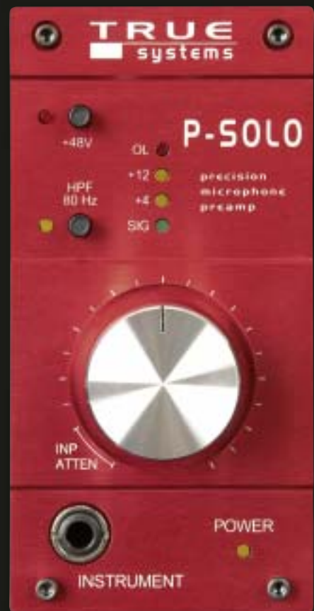
Die Front des P-SOLO. Der große, sehr gut zu bedienende Pegelregler weist eine Besonderheit auf: Steht er auf Links-Anschlag, arbeitet der P-SOLO im Low-Gain-Betrieb. Der Regler rastet nämlich in der sogenannten INP ATTEN-Stellung ein. Damit ist eine feste Verstärkung von lediglich sechs Dezibel fest und unveränderlich eingestellt.
