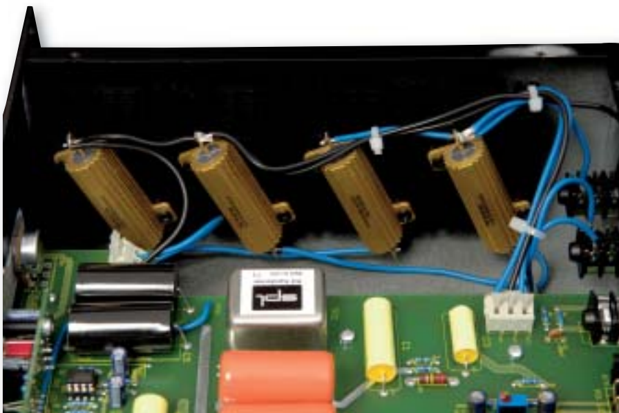
Das klangentscheidende Innenleben des Transducer ist sehr sauber verarbeitet. Die Herkunft der Leistungswiderstände (ganz links) und der OPs verbirgt SPL, um nicht zu viele Details zu verraten. Der Übertrager mit dem SPL-Logo ist eine Sonderanfertigung des Trafospezialisten Lehle.
