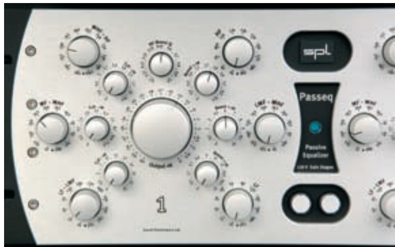
Sternförmig verteilen sich Frequenzwahlschalter und Verstärkungs-/Dämpfungsregler um den wichtigen Lautstärkereger herum. Links werden Frequenzen bedämpft und rechts verstärkt. Auffällig ist der Güte-Regler für das Höhenband und die unterschiedliche Auslegung der Filterfrequenzen auf beiden Seiten.
