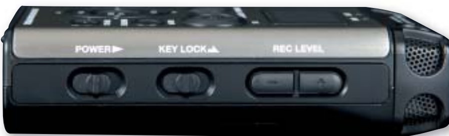
Der PMD620 lässt sich problemlos mit einer Hand bedienen: Die Transportbuttons übernimmt der Daumen, die Rec-Level-Taster der Zeigefinger der linken Hand.
