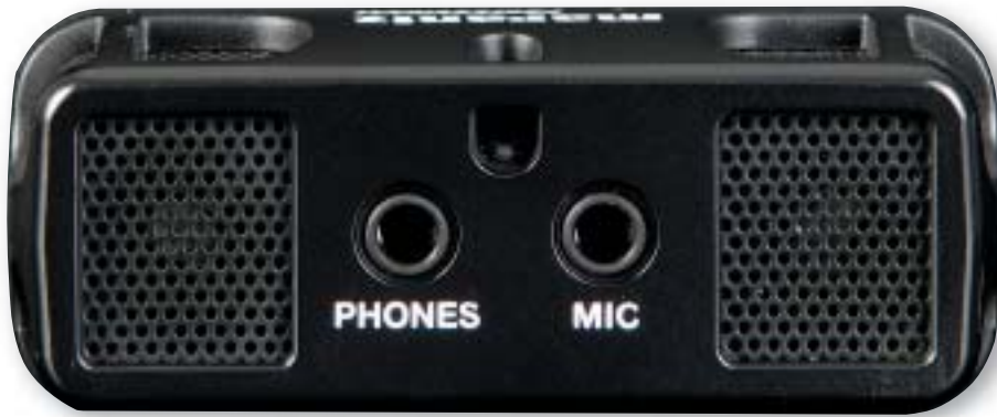
Die beiden Mikrofonkapseln sind sicher durch eine dünnes Lochblech geschützt und leicht nach oben und außen abgewinkelt.
