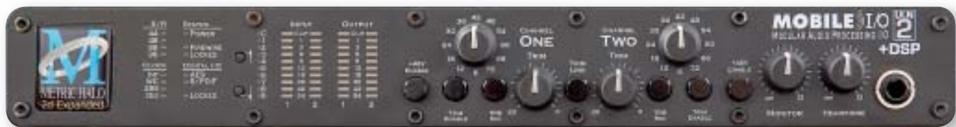
Die Bedienelemente des Mobile I/O ULN2 2d Expanded Audio-Interface dienen zur Einstellung der beiden Analog-Eingänge. Monitor- und Kopfhöerausgang führen dasselbe Signal, lassen sich aber separat in der Lautstärke regeln.
