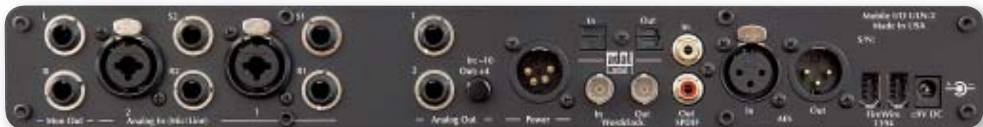
Das zweikanalige Mobile I/O ULN2 hat in der 2d Expanded-Version erstmals eine ADAT-Schnittstelle erhalten. Besonderheit: Die 4-Pin-Buchse erlaubt den Anschluss von professionellen Broadcast-Akkus.
