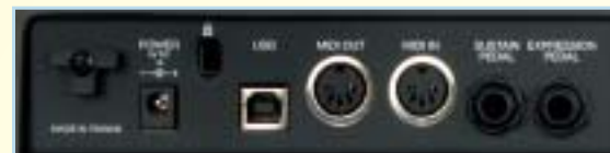
Das MPK 49 lässt sich wahlweise über USB oder die Netzgerätebuchse mit Strom versorgen. Ein Netzgerät wird jedoch nicht mitgeliefert.
