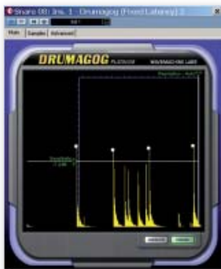
Der Visual-Dialog erlaubt auf der Main-Seite die Anpassung der Sensitivity und Resolution Parameter. Zumeist reicht die Anpassung des Schwellenwertes, sprich Sensitivity, aus, um ein richtiges Triggern, erkennbar an den weißen Punkten, zu ermöglichen. Jeder Transient, der über die horizontale Linie geht, stellt ein Trigger-Ereignis dar.
