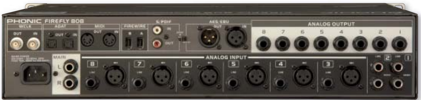
An Anschlüssen mangelt es dem Firefly 808 mit Sicherheit nicht. Neben den acht analogen Ein- und Ausgängen erweitert die ADAT-Schnittstelle das Interface um acht digitale Kanäle in beide Richtungen.
