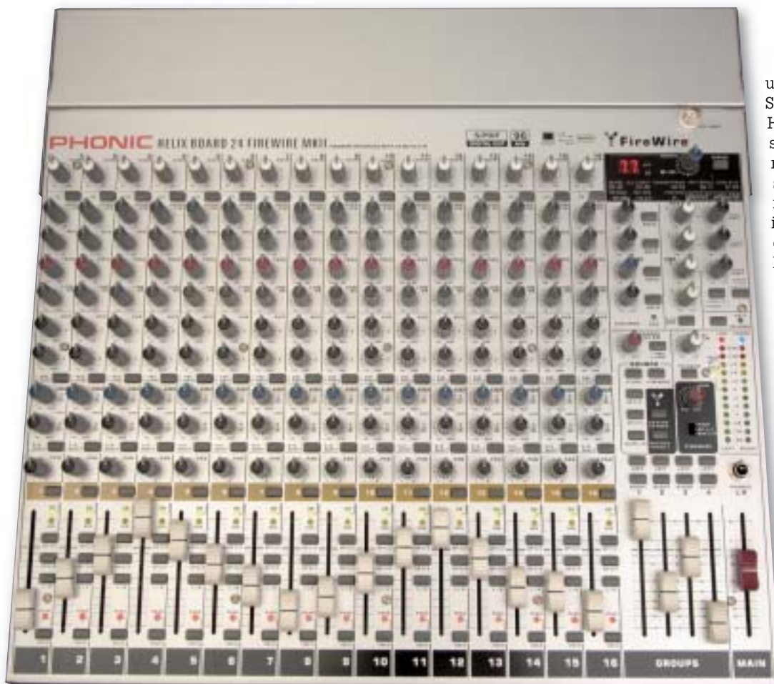
Das Layout der Pultoberfläche ist übersichtlich. Wegen der kompakten Abmessungen des Pultes, drängen sich die Bedienelemente und Regler dicht zusammen. Dennoch ist die Bedienung gut.
