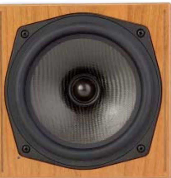
Beim C 5 tiny setzten KS digital auf eine koaxiale Bauweise: Der Hochtöner sitzt im Zentrum des Tieft-Mitteltöners, der gleichzeitig als Wave-Guide für den Hochtöner fungiert.
