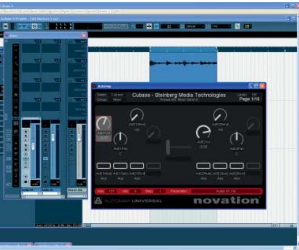
Nocturn steuert auch den Mixer in Cubase zumindest grundlegend. Besonders pfiffig: Mit Hilfe des Speed-Dials wählen wir den zu steuernden Send-Kanal. Welcher Kanal ausgewählt ist, wird im Fenster des Automap-Servers wiedergegeben.
