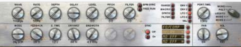
Das Instrumenten-Plug-in von Sampletron bietet dieselbe Ausstattung wie das Samplemoog-Instrument. In der oberen Menüleiste können per Knopfdruck Filter, LFOs und Hüllkurven aufgerufen werden. Die untere Menüleiste ist der Programmierung der insgesamt 32 Effekte vorbehalten.
