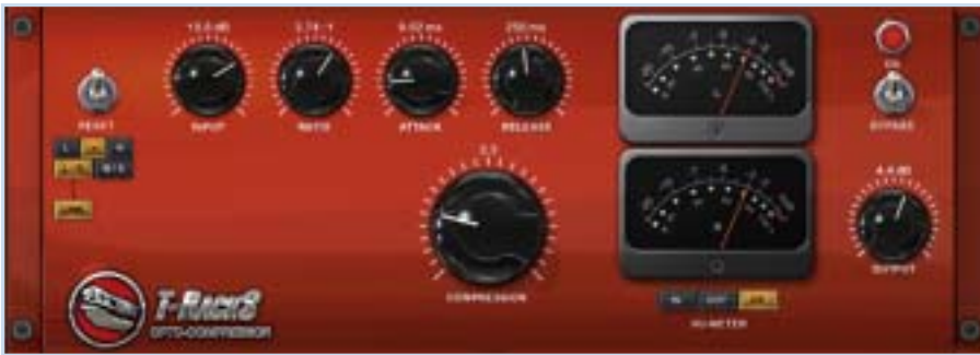
Der Opto-Compressor emuliert ein optisches Regelglied und erzeugt eine weiche und unauffällige Kompression in Soft-Knee-Charakteristik. Im Vergleich zum Classic-Compressor der Vorversion greift er sehr behutsam ins Programm-Material ein. Bemerkenswert: Mit dem Link-Button lässt sich bei Bedarf die exakt gleiche Kompressionsstärke auf beide Kanäle anwenden.
