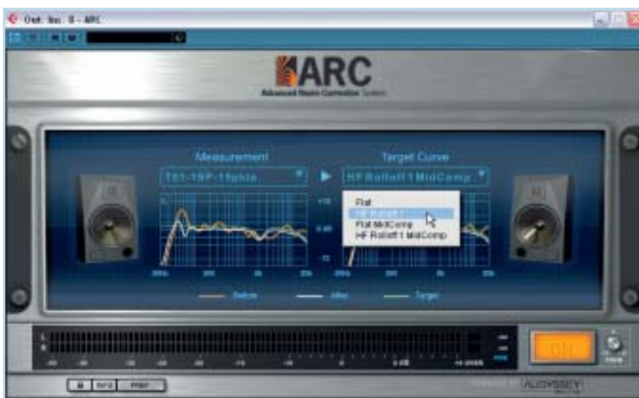
Die von der Mess-Software errechnete Raumanalyse wird als Datei in das ARC-Plug-in geladen. Vier Zielkurven stehen zur Auswahl, die einen nachträglichen Eingriff in das zu korrigierende Signal erlauben. Die Diagramme zeigen dabei die analysierten Frequenzgänge, sowie die verwendete Zielkurve und das daraus errechnete und korrigierte Ergebnis. Das Plug-in selbst wird schließlich als Insert auf die Mastersumme des Sequenzers geroutet.
