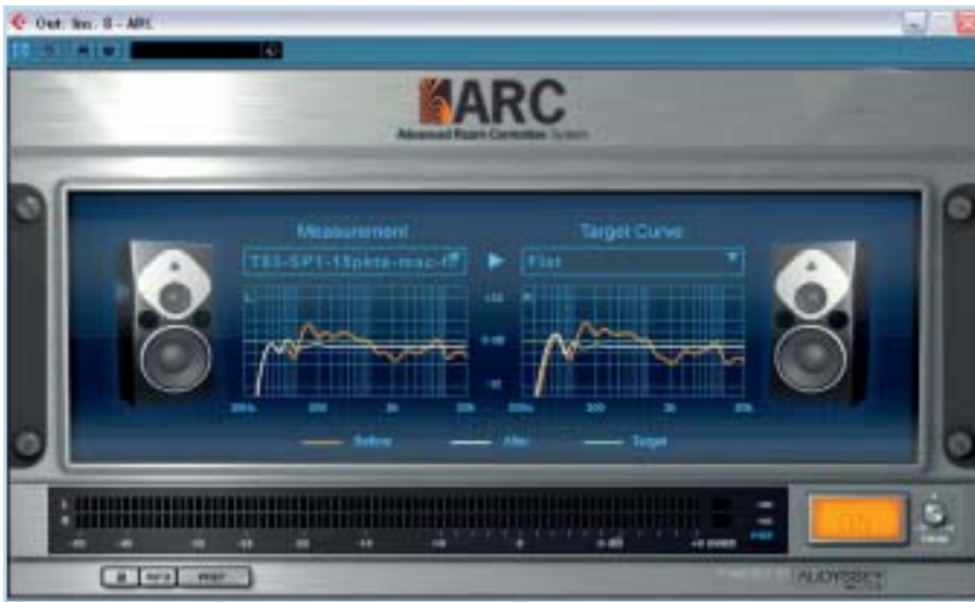
Die orange Kurve zeigt das vom ARC System analysierte Ergebnis, das beim Test mit den Mackie HR624 MK2 Monitoren im nicht optimierten Redaktionsraum von Professional audio Magazin entstanden ist.
