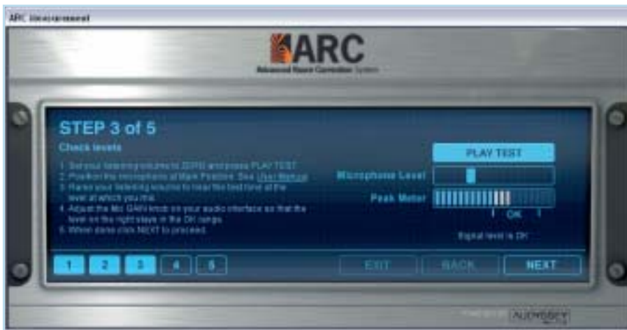
Die als Stand-alone-Variante ausgeführte Mess-Software führt den Anwender mit einem fünfstufigen Programm Wizard sicher und bequem durch das Setup des Systems und den eigentlichen Messvorgang.
