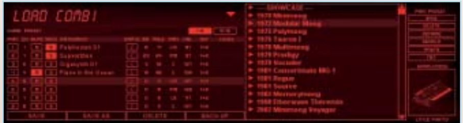
SampleMoog erlaubt den gleichzeitigen Einsatz von 16 Presets in einer Instanz, die in Lautstärke, MIDI-Kanal, Panorama, Polyphonie und Ausgang feinstjustierbar sind. Das Ablesen der kontrastarmen roten Schrift auf schwarzem Grund ist jedoch nicht leicht.
