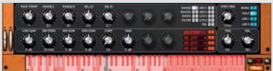
Bei aktiviertem Zonen-Button zeigt die virtuelle Klaviatur die Verteilung der Multisamples. Über die Regelmöglichkeiten des Range-Dialgs lassen sie sich auf der Tastatur und in der Anschlagsdynamik neu verteilen und einstellen.
