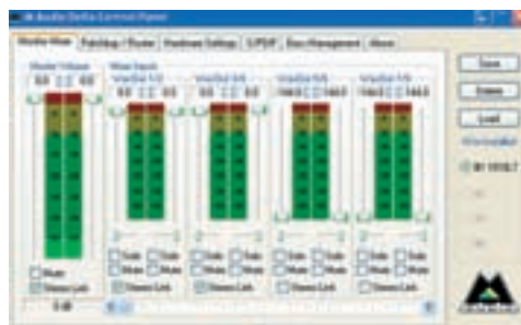
Insgesamt fünf Reiter bieten umfangreiche Möglichkeiten zur Einstellung der Delta 1010LT-Karte. Besonderes Feature ist der Bass-Management-Dialog, der Regelmöglichkeiten für Surround-Sound Anwendungen enthält.
