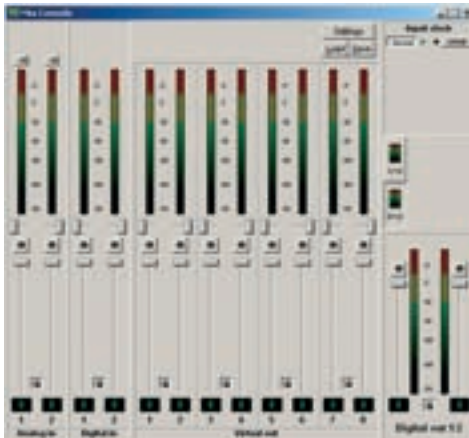
Einfach und intuitiv bedienbar präsentiert sich der virtuelle Mixer der Mia MIDI-Karte. Ein- und Ausgangssignale lassen sich zwischen -10 und +4 dB einstellen.
