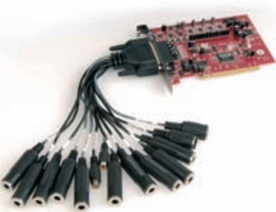
Die Phase 28-Karte enthält als Besonderheit auf dem Slot-Blech zwei Trim-Potis zur Einstellung der Eingangsempfindlichkeit der separaten Vorverstärker. Mit acht analogen symmetrischen Ausgängen lassen sich flexible Ausgangsroutings erstellen.
