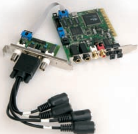
Die Marc X-Karte von Marian besteht aus einer Haupt- und einer Erweiterungskarte. Ihr Schwerpunkt liegt auf digitalen Anschlüssen. Der analoge Stereo Ein- und Ausgang lässt sich jedoch mit der Zusatzkarte ANX auf insgesamt sechs erhöhen.
