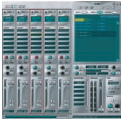
Der Mischer des EMU-Systems erlaubt die Integration von 28 internen Effekten sowohl in die Kanäle, als auch in die Mastersektion. Das Routing und die Bedienung ist allerdings gewöhnungsbedürftig.
