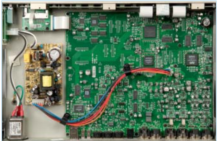
Im Inneren des PCM 96 werkelt ein mit 300 MHz getakteter ADSP-TS1015 TigerSHARC-Prozessor von Analog Devices (Mitte rechts) unterstützt von mehreren FPGAs.
