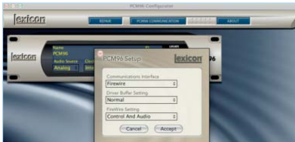
Über den Firewire-Port lassen sich grundlegende Einstellungen auch komfortabel vom Rechner aus vornehmen. Die übersichtliche Steuersoftware „PCM96 Configurator“ ist bisher allerdings nur auf dem Mac nutzbar.
