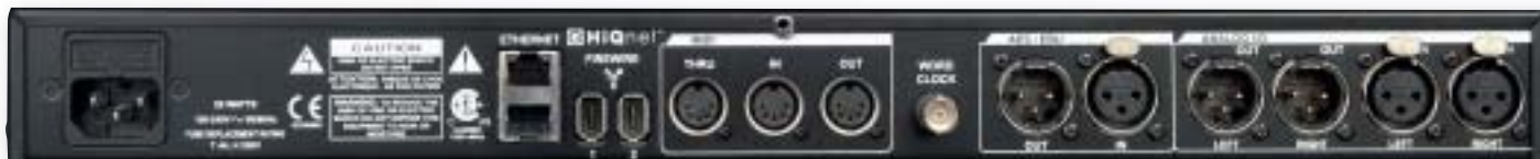
Der PCM 96 ist zweikanalig aufgebaut und verfügt über analoge und digitale Ein- und Ausgänge – letztere im AES/EBU-Format. Neben der Möglichkeit der MIDI-Steuerung kann das Gerät über die Firewire-Ports (Mitte) auch als DSP-Plug-in auf dem Mac eingesetzt werden. Auch für die Einbindung in ein LAN-Netzwerk ist der PCM 96 gerüstet.
