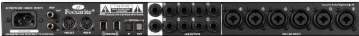
Die Rückseite vereint sechs analoge Eingänge – als Combo-Buchsen realisiert. Ausgangsseitig stehen zehn servosymmetrische Klinkenbuchsen zur Verfügung. Der Reigen an Anschluss-Möglichkeiten wird von einer coaxialen S/PDIF-Schnittstelle, optischen Toslink-Anschlüssen (wahlweise Adat oder S/PDIF) und einem MIDI-Buchsen-Duo komplettiert.
