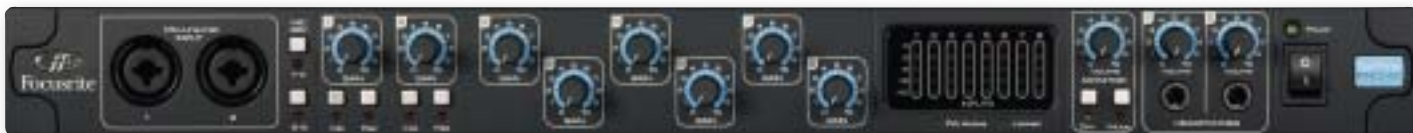
Die Drehregler am Saffire PRO 40 steuern ausschließlich die Pegel der analogen Eingänge. Die zwei Combo-Buchsen besitzen eine schaltbare Hi-Z-Funktion zum Anschluss elektrischer Instrumente. Das Display gibt per 5-Segment LED-Kette Auskunft über die Pegel an den Eingängen. Besonderheit: Der Monitorregler ist in der Lage, bei Bedarf alle zehn analogen Ausgänge gleichzeitig in der Lautstärke zu kontrollieren.
