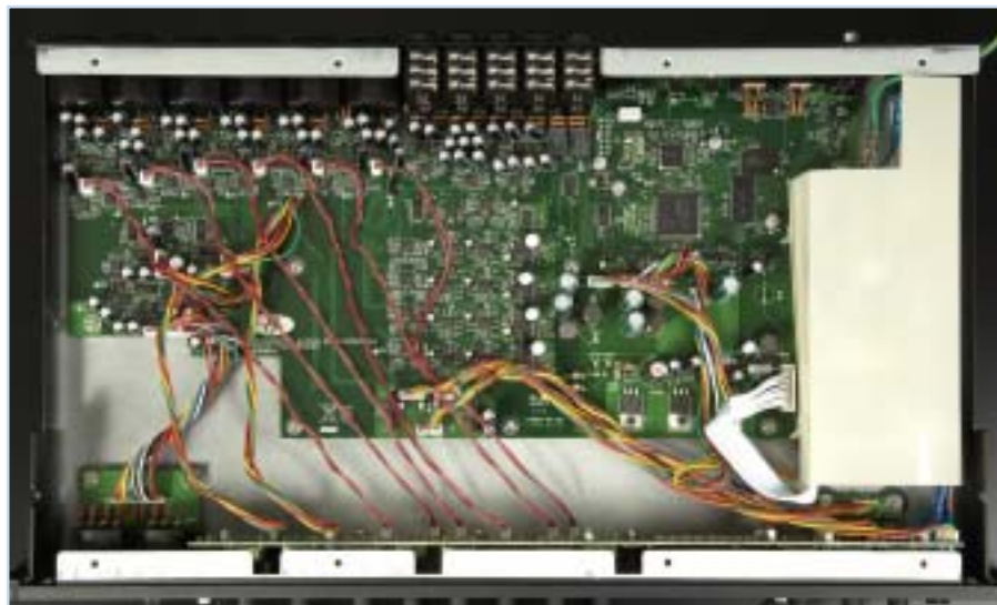
Das Innenleben des Focusrite Saffire PRO 40 zeigt sich akkurat und sauber verarbeitet. Der große quadratische Chip auf der Hauptplatte berechnet den internen DSP-Mixer. Das integrierte Netzteil findet sich – vorschriftsmäßig von der Hauptplatte getrennt – unter der hellen Abdeckung.
