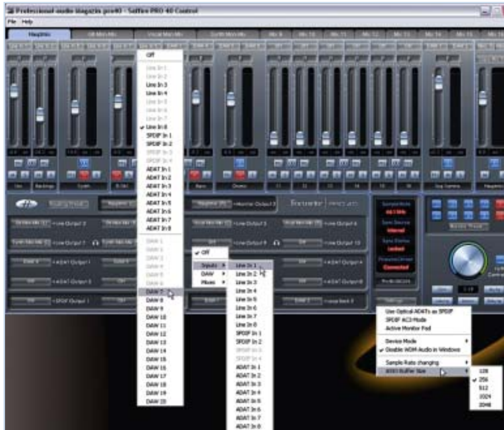
Das Routing der physikalischen Ein- und Ausgänge sowie der virtuellen DAW-Kanäle auf die Mixer-Dialoge und die Ausgänge des Audio-Interface ist durch Aufruf von Auswahl-Menüs gelöst. Durch Druck auf den Settings-Button erreicht man zusätzliche Funktionen zur globalen Einstellung des Saffire PRO 40.
