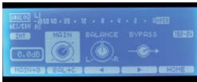
Wer auf höchste Qualität bei der Aufnahme Wert legt, sollte den Schaltkreis für Eingangspegel und Balance umgehen und „Bypass“ aktivieren.
