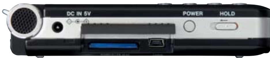
SD-Karten-Slot und USB-2.0-Schnittstelle sind hinter einer leicht zu öffnenden Klappe an der Flanke verborgen.
