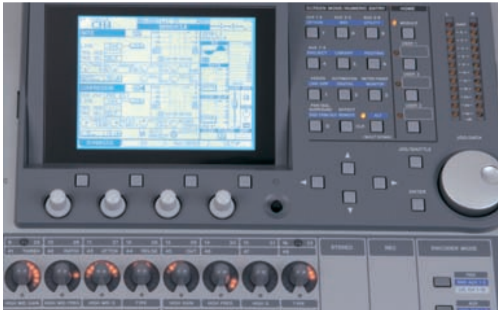
Zentrales Bedien- und Informationszentrum des DM 3200 ist die Control Section mit LCD-Bildschirm. Die zum Teil recht komplexen Einstellungen in den Channelstrips lassen sich hier problemlos erledigen.
