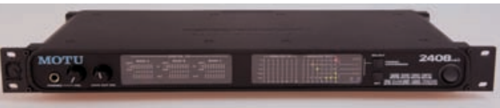
Der MOTU 2408MkII dient im Test als TDIF-Interface für den Apple PowerPc.
