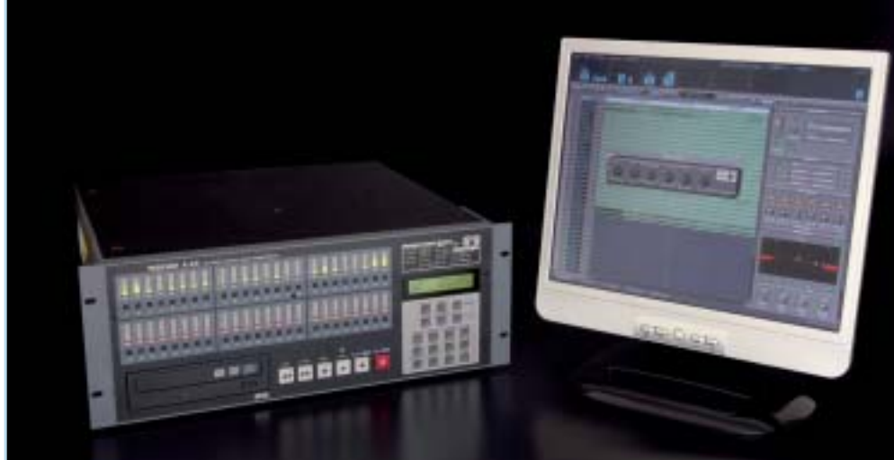
Mit angeschlossenem VGA-Computer-Monitor offenbart sich das Hybrid-Konzept der X-48: Die Workstation hat einen virtuellen Mixer, eigentlich ein proprietärer Sequenzer auf der Basis des Tascam Gigastudio.
