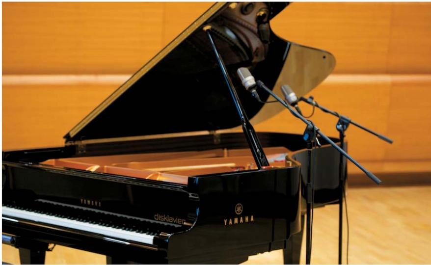
Der Disklavier-Flügel von Yamaha wurde für den Test mit einem Paar Neumann TLM103 und den Röhrenmikros M149 stereo abgenommen. Es wurden jeweils zwei Aufnahmen zum Vergleich gemacht, einmal über Vovox Sonorus Direct S und einmal über herkömmliche Studiokabel.
