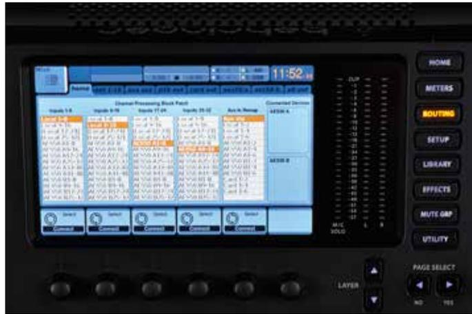
Volle Kontrolle: Die zentrale Bedieneinheit lässt alle Funktionen des X32 auf dem sieben Zoll-LC-Display konfigurieren.
