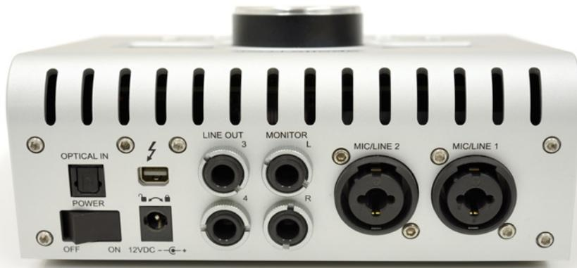
Das kompakte Apollo Twin ist das erste Universal Audio Interface mit ab Werk integrierter Thunderbolt-Schnittstelle. Der Toslink-Eingang dient zum Einspeisen wahlweise von S/PDIF- oder ADAT-Signalen, was die Zahl verfügbarer Eingänge auf maximal zehn erhöht.
