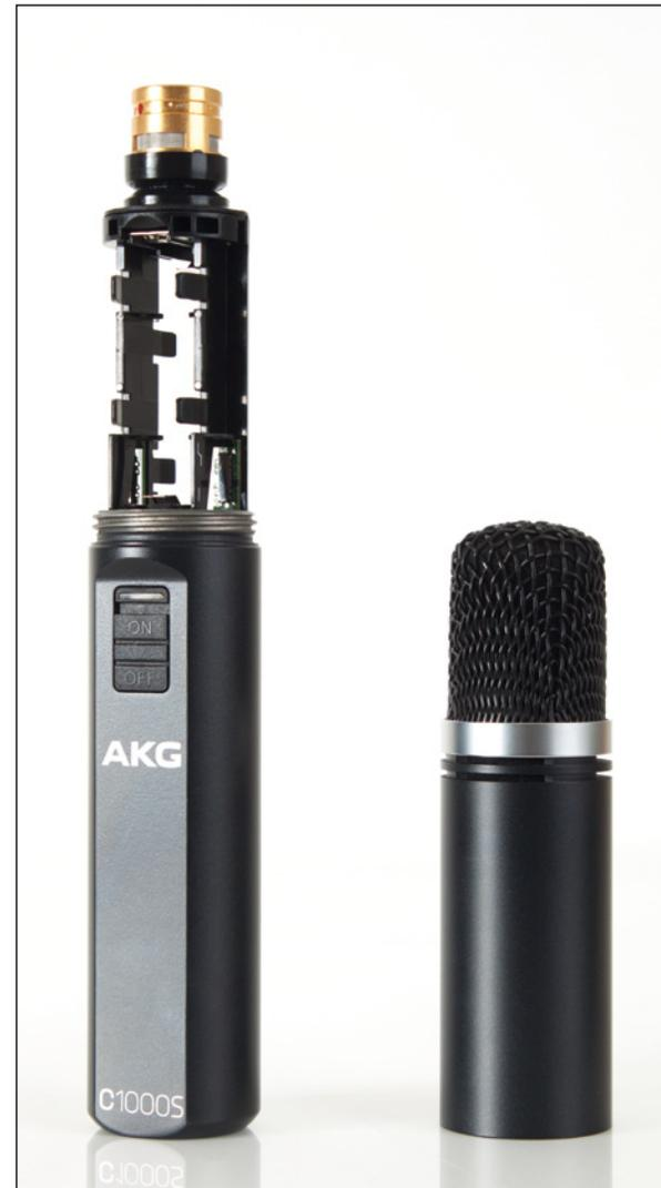
*Die Kapsel des C 1000 S ist zum Aufstecken der Adapter frei zugänglich und über eine flexible Gummihalterung mit dem Kunststoffbatteriefach verklebt.*
