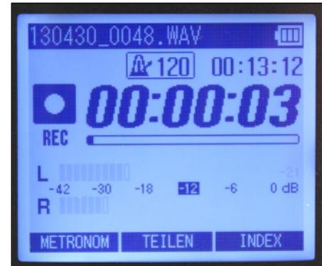
Das Metronom kann entweder während der Aufnahme oder, wenn die Aufnahme pausiert wird, zugeschaltet werden.
