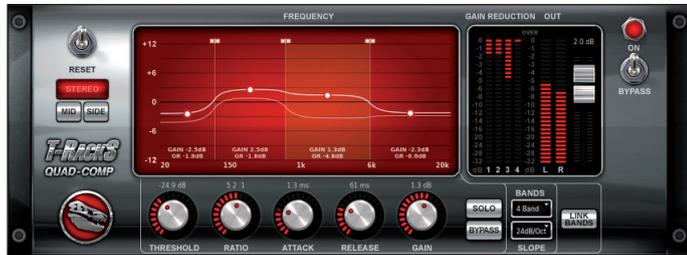
Neu in der CS Grand Ausgabe von T-Racks sind auch die sogenannten Quad-Series-Prozessoren, Multi-Band-Effekte mit maximal vier einstellbaren Bändern. Ein Kompressor darf dabei nicht fehlen.
