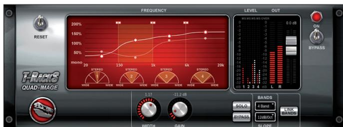
Der Quad-Image Prozessor arbeitet per se im M/S-Modus und erlaubt das frequenzselektive Ändern der Stereobasis von mono bis hin zu überbreitem Stereo.
