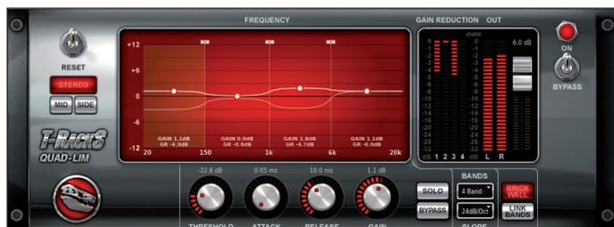
Der Quad-Limiter arbeitet mit Peak Charakteristik und erlaubt, wie übri-gend auch die anderen Quad-Effekte mit Ausnahme des De-Essers Stereo-, Dual-Mono- und M/S-Bearbeitung.
