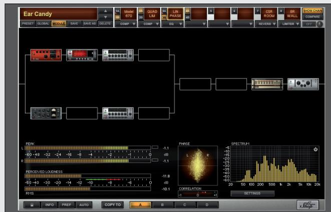
Die neue T-Racks Custom Shop Version basiert im Kern auf T-Racks 3. Bis zu zwölf Prozessoren sind einsetzbar, wobei gleichzeitig parallele und serielle Signalverarbeitung möglich ist.
