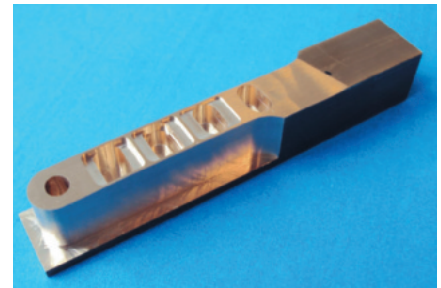
Die ABM-Brücke wird aus dem massiven Messing heraus gefräst.
