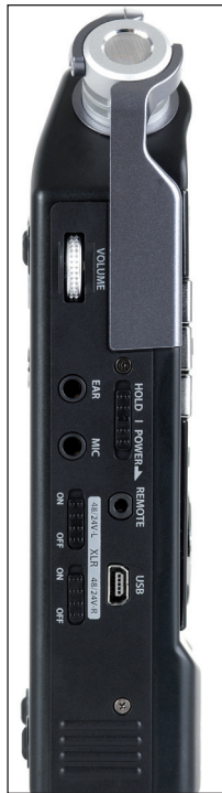
Die Remote-Buchse dient zum Anschluss einer Infrarot-Fernbedienung wie der RS30W von Olympus und ermöglicht das körper-schallfreie Bedienen des LS-100.
