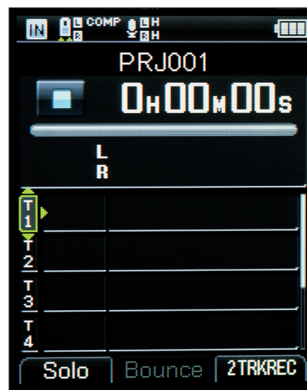
Im Multitrack-Modus lassen sich acht Mono- oder vier Stereospuren untereinander aufnehmen, rudimentär abmischen und in eine Datei bouncen.
