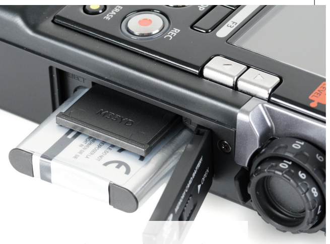
Der SD-Karten-Slot – SDHC und SDXC-Karten bis 64 Giga-byte sind kompatibel – befindet sich zusammen mit dem Akku-Fach hinter einer sicher verriegelbaren Klappe.
