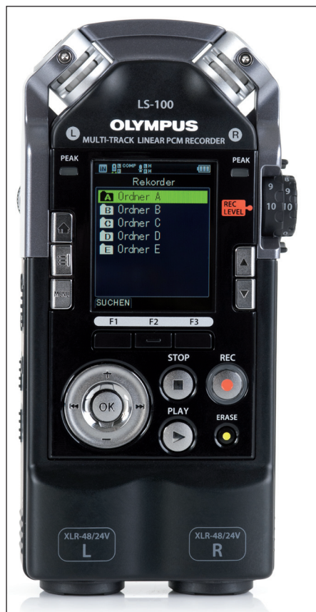
Neben dem Navigationskreuz und dem Menü-Button (links neben dem LCD), sind die drei belegbaren Funktionstasten (F1-F3) für den direkten Zugriff auf bestimmte Features sehr hilfreich.
