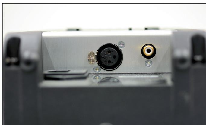
Die beiden Anschlüsse – XLR und RCA/Cinch – sind nach unten zeigend angebracht.
