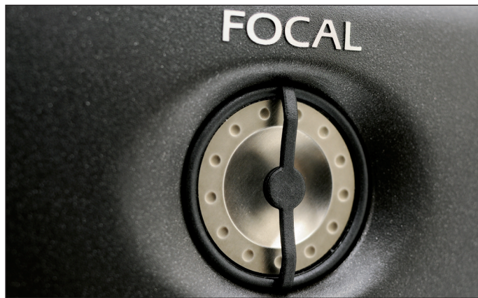
Beide Chassis werden mit metallenen Schutzgittern ausgeliefert, die entfernt werden sollten. Das sogenannte Phase-Plug ist einfach vor dem Hochtöner zu montieren und dient der Phasenzentrierung.
