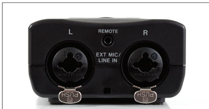
An die XLR/Klinke-Combo-Buchen lassen sich sowohl externe Mikrofone als auch Line-Signale, beispielsweise von einem Mischpult beim Livemitschnitt, anschließen.
