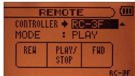
Ist der Controller RC-3F an die Remote-Buchse angeschlossen, stehen unterschiedliche Modi der Fußtasterbelegung zur Verfügung.
