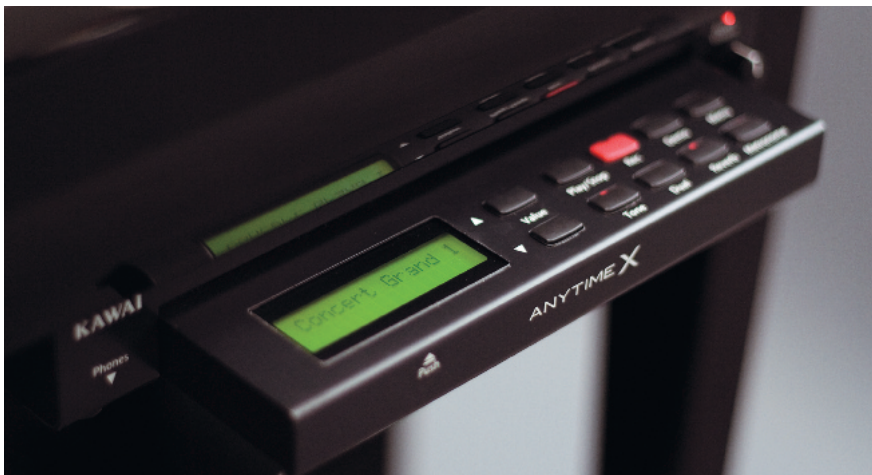
Das Bedienfeld für den Digitalteil gleitet nach dem Andrücken unter der Tastatur hervor. Die digitale Einheit mit ihren Anschlüssen verbirgt sich direkt dahinter.
