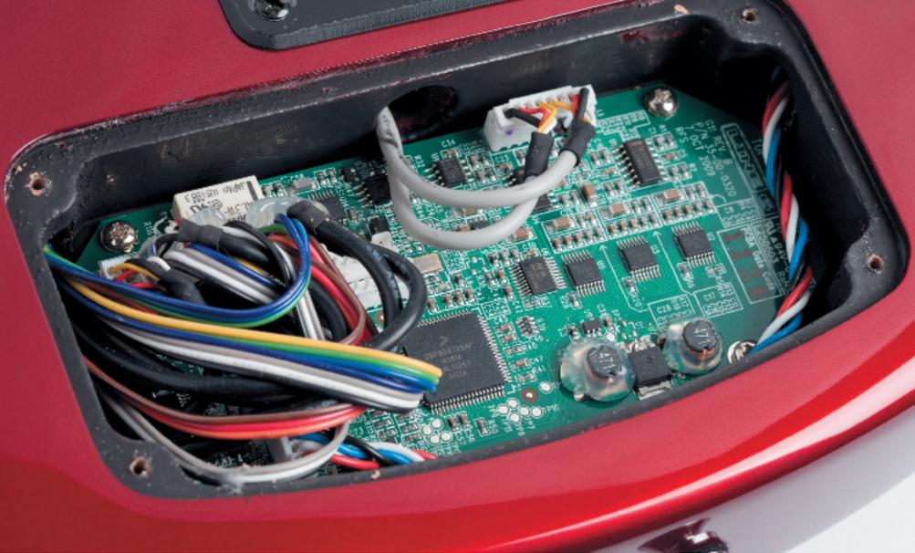
Verbindung zum hexafonen Piezo-PU, und Heimat von 25 Gitarrenmodellen
