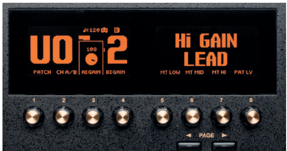
Displays mit 8 Parameterreglern
