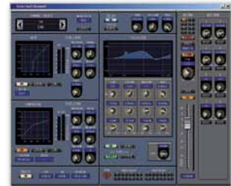
Speziell Routings und Effekt-Einstellungen gehen mittels Editing-Software sehr viel schneller von der Hand, da das GUI alle relevanten Informationen in einem Fenster zeigt.
