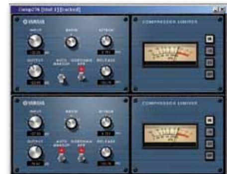
Der integrierte Effekt-Prozessor des 01V96i hat es in sich: Der „Comp276“ ist eine Emulation des legendären Urei 1176, die dank Yamahas VCM-Technologie einen vergleichbaren Biss hat – ideal für Gesangsaufnahmen.
