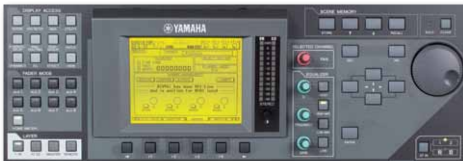
Das monochrome LC-Display mit den Hauptbedienelementen ist die Kommandozone des 01V96i.
