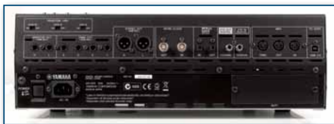
Dank bidirektionaler USB 2.0-Schnittstelle mit 16 I/O und MIDI In/Out ist das Pult auch als Aufnahme- und Steuerzentrale im rechnerbasierten Studio voll einsetzbar.
