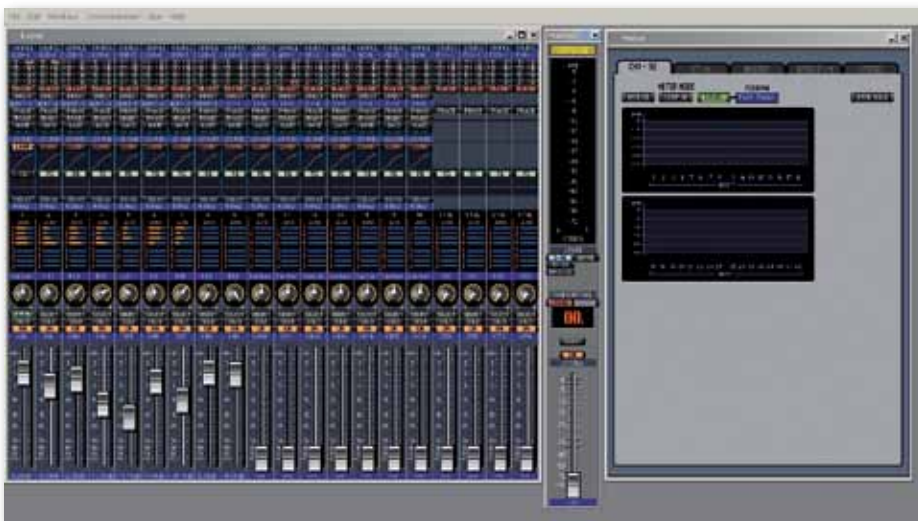
Mit der Editing-Software Studio Manager V2 ist die Steuerung des 01V96i über einen Rechner deutlich komfortabler möglich als an der Hardware selbst.
