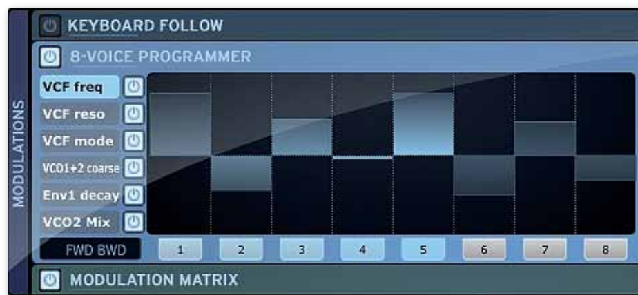
Mit Hilfe des 8-Voice-Programmers emuliert der Oberheim SEM V acht monophone Synthesizer, die sich individuell in sechs Parametern editieren lassen.
