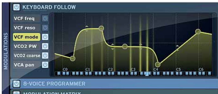
Der Keyboard Follow Editor erlaubt opulente und vielfarbige Parameter-Modulationen in Abhängigkeit zum Spiel auf der Tastatur.
