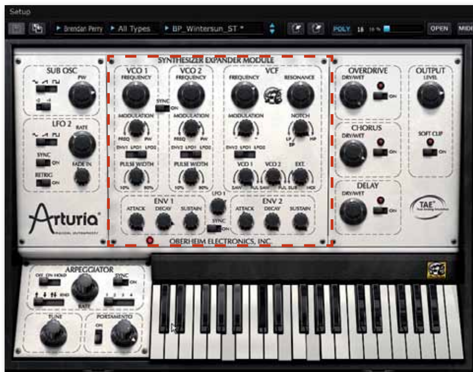
Arturias jüngster Wurf reproduziert im Kern den Oberheim SEM-Synthesizer (siehe rote Markierung), der mit einer Reihe zusätzlicher Features angereichert wird wie etwa ein Arpeggiator, Sub-Oszillator oder ein zweiter LFO.
